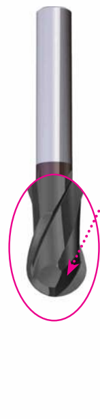
정밀도 향상 및 안정성 확보 (R 공차 : ± 5μm, 직경 공차 : 0~10μm ; D≤6mm)
